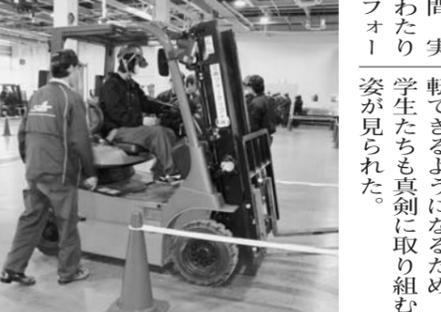
り、最大荷重1t以上のフォークリフトの操作資格が取得可能である。講習は、学科7時間、実技24時間の長時間にわたって行われ、学科では、フォークリフトの機能・仕組み・取扱い、力学や運転方法、関係法令・検査法令などを学び、実技では、点検から乗車・発進・走行・荷役の操作までを学んだ。
